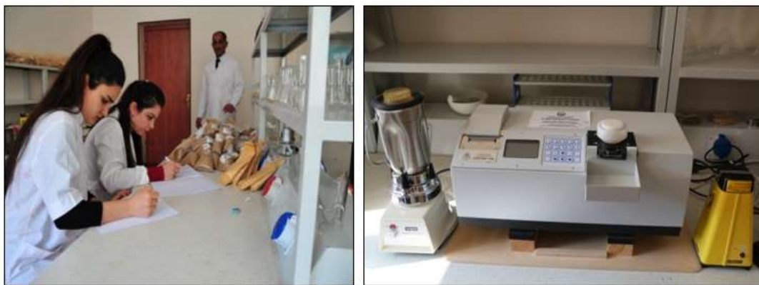
Şəkil 1, 2. “Анализатор инфрокрасный Спектран-119М, ЛОМО фотонка плюс” cihazı ilə soyanın keyfiyyət analizinin aparılması.
